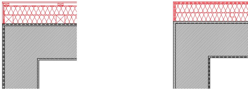
Abbildung 3.6.3 Konstruktionsprinzip Lösungsansatz a) Unterbrechung der Dämmebene; links: vorgehängte hinterlüftete Fassade, rechts: Wärmedämmverbundsystem
