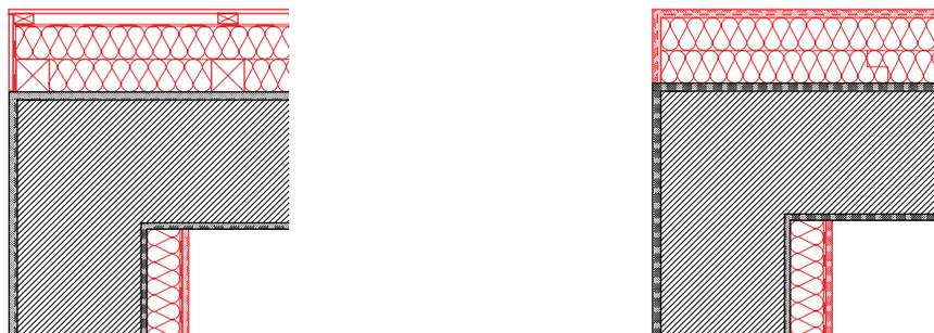
Abbildung 3.6.5 Konstruktionsprinzip Lösungsansatz c) Kombination von Innen- und Außendämmung; links: vorgehängte hinterlüftete Fassade, rechts: Wärmedämmverbundsystem
