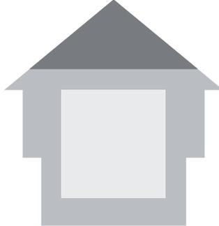
Abbildung 3.2.2 Schlagregenbeanspruchung einer Giebelwand: dunklere Bereiche sind mehr, hellere Bereiche weniger schlagregenbeansprucht, nach [Künzel 1996]
