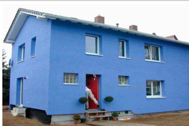
12 cm WDVS mit Erneuerung der Fenster, Dämmung von Dach und Kellerdecke
