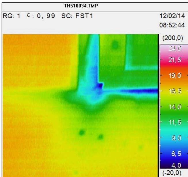
Abbildung 6-15: Türanschlussbereich unten, IR-Aufnahme 034
