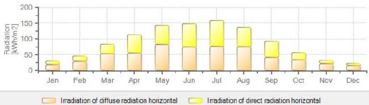
Abbildung 11-4: monatliche Einstrahlung durch diffuse und direkte Strahlung
